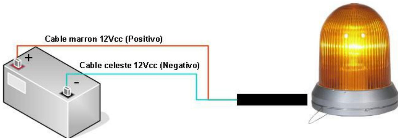
La conexión se realiza a través de un cable **MARRON** que se conecta al **POSITIVO** de la alimentación; y conectándose el **NEGATIVO** a un cable **CELESTE**, siendo la alimentación de **12v de corriente continua**.
