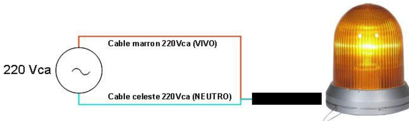
La conexión se realiza a través de un par de cables envainados de colores estandar para alimentación en líneas de 220vca, un cable **MARRON** que se conecta al **VIVO**, y un cable **CELESTE** que se conecta al **NEUTRO**, siendo la alimentación de **220v de corriente alterna**.
