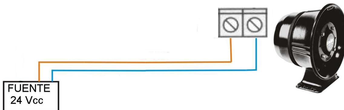
La sirena EMAVE dispone de una bornera para alimentar con 24 Vcc . El diagrama de conexión de la misma se muestra en el gráfico anterior.
